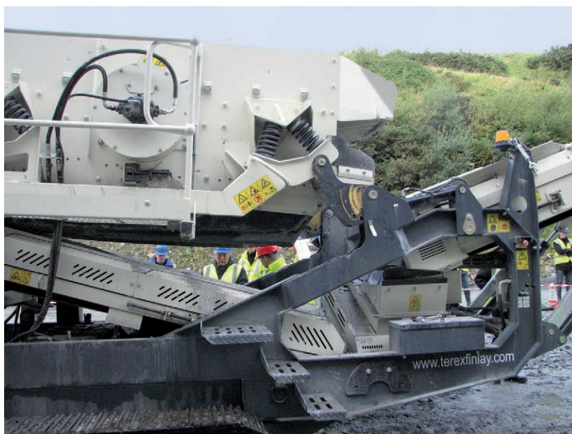
Unikátní hydraulické „přizvednutí“ třídiče pro snazší přístup při čištění, nebo výměně sítí
