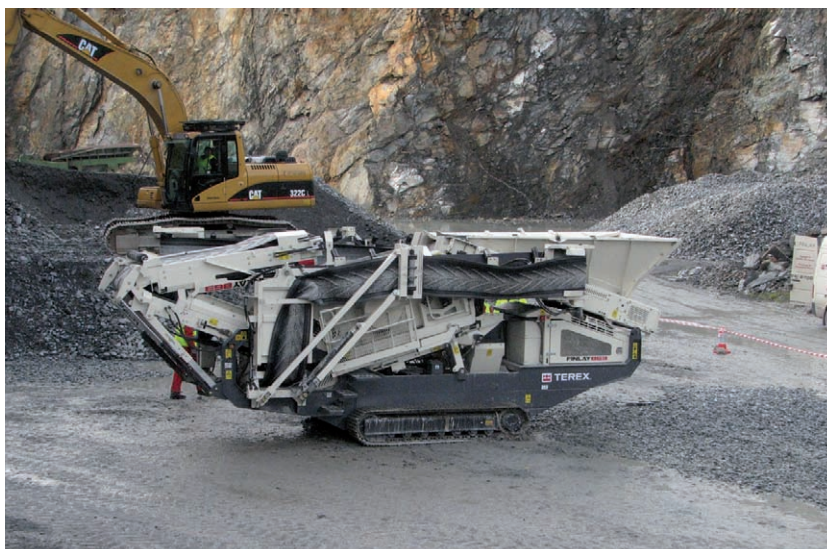
Složení stroje z pracovní do přepravní polohy a naopak nezabere více než několik minut
