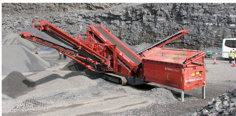
Třísitný třídič FINLAY 684
