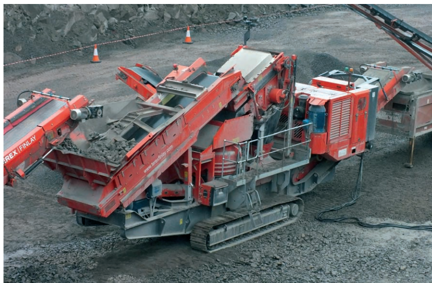
Kuželový drtič FINLAY C-1540
